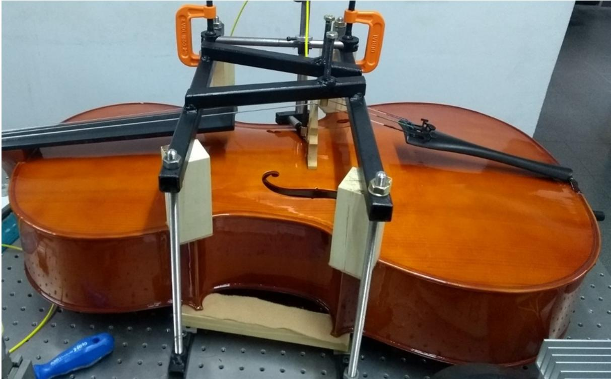
Imagen 3 – Violonchelo montado en la mesa de medición mediante la estructura de fijación
