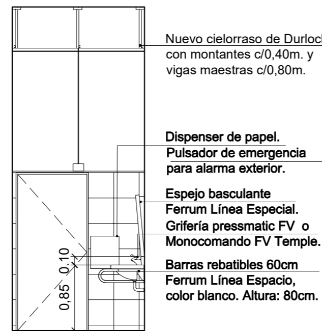
VISTA LATERAL LAVATORIO
